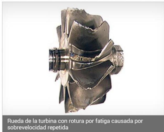
Rueda de la turbina con rotura por fatiga causada por sobrevelocidad repetida
