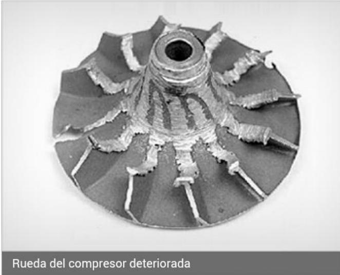
Rueda del compresor deteriorada
