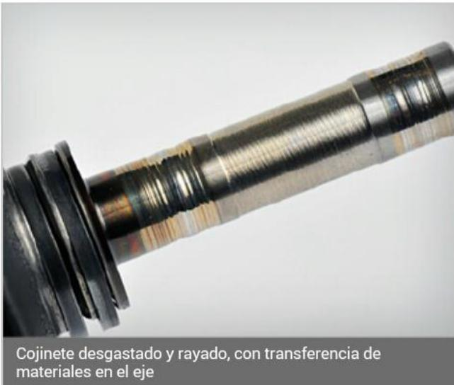
Cojinete desgastado y rayado, con transferencia de materiales en el eje
