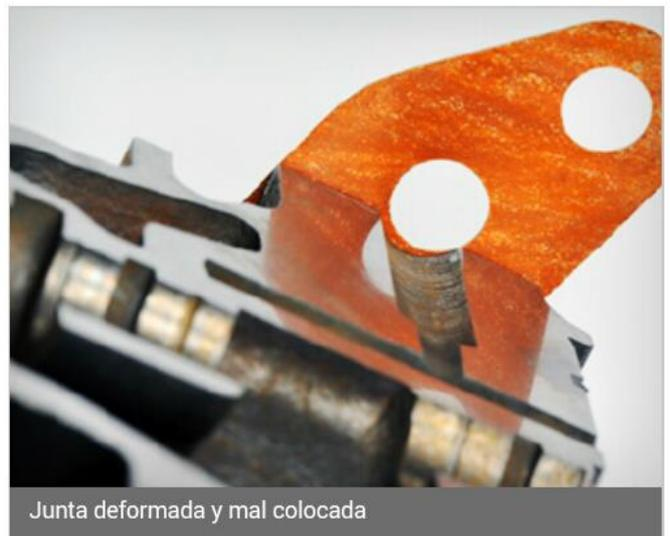
Junta deformada y mal colocada
